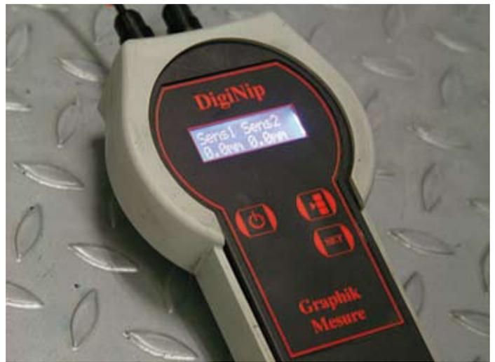
Das Quick Check DigiNip: Ein Messgerät für die präzise und einfache Kontrolle der Einstellung von Farb- und Feuchtwalzen in Druckmaschinen.
